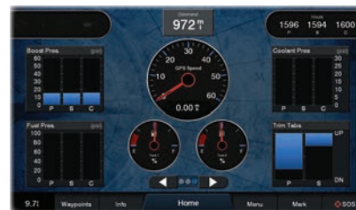
Adaptive Trim Tab System kan vise indstillinger på MFD display via NMEA2000
